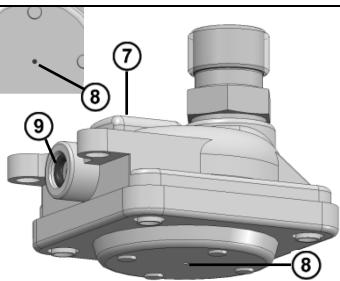
Lorsque le corps gonflant ⑧ est aspergé avec du fuel dans le couvercle du détendeur de pression du fuel ⑦ :
